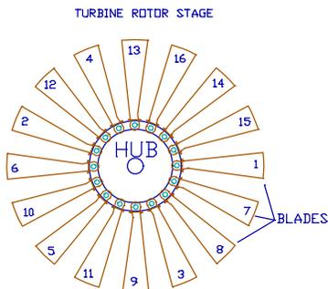
STEP 4. ASSEMBLE ROTOR STAGE USING OPTIMUM DISTRIBUTION.
