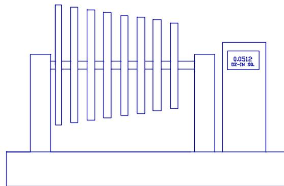
STEP 8. BALANCE COMPLETE ROTOR ON A HORIZONTAL TWO-PLANE SPIN BALANCE MACHINE.
