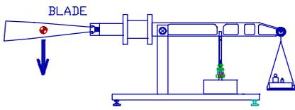
BLADE BALANCE MACHINE ("MOMENT WEIGHT SCALE")
