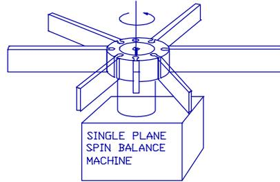
STEP 5. BALANCE ROTOR STAGE ON SINGLE PLANE SPIN BALANCE MACHINE. ADD BALLAST TO HUB OR SWAP BLADES.
