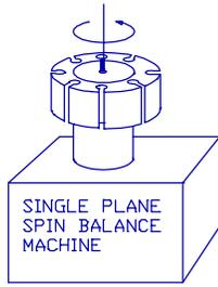
STEP 1. MEASURE HUB UNBALANCE USING SINGLE PLANE SPIN BALANCE MACHINE
